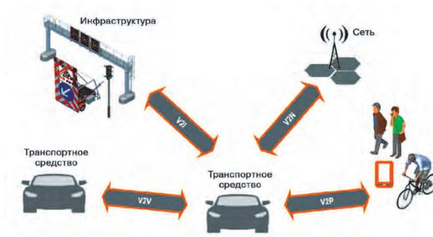
Рис. 1. Схематическое изображение системы V2X
