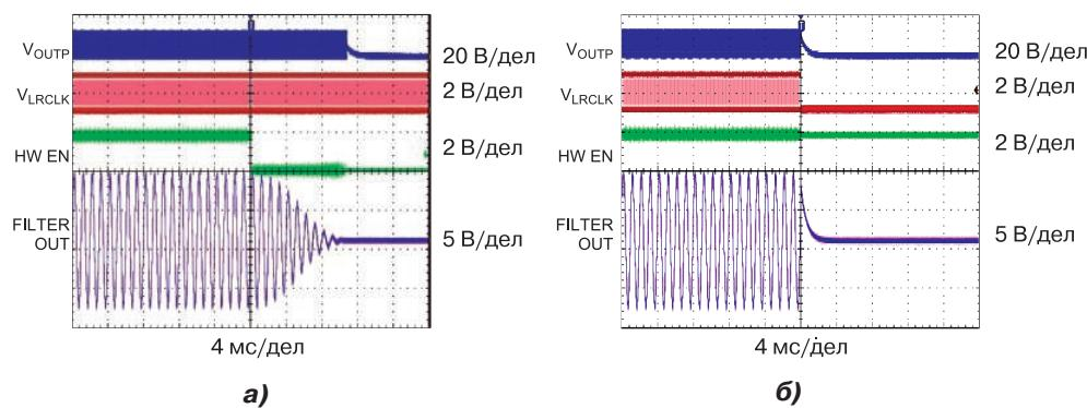
**Рис. 4. Осциллографмы управляющих и выходных сигналов MAX98365 при выключении усилителя сигналом HW EN (а) или отключением сигнала синхронизации VLCLK (б)**
