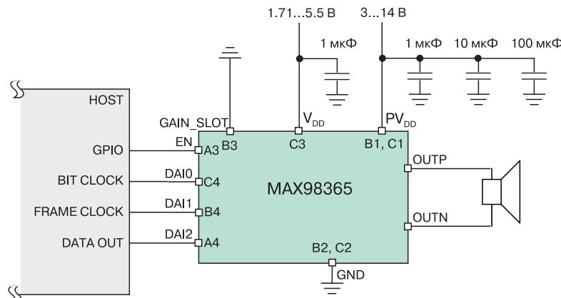
**Рис. 2. Типовая схема включения усилителя MAX98365**
