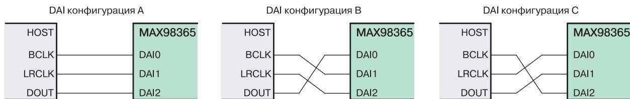
Рис. 6. Расположение выводов LRCLK и DIN при подключении сигнала BCLK кодному из выводов DAI
