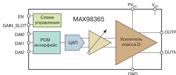
**Рис. 1. Структурная схема усилителя MAX98365**
