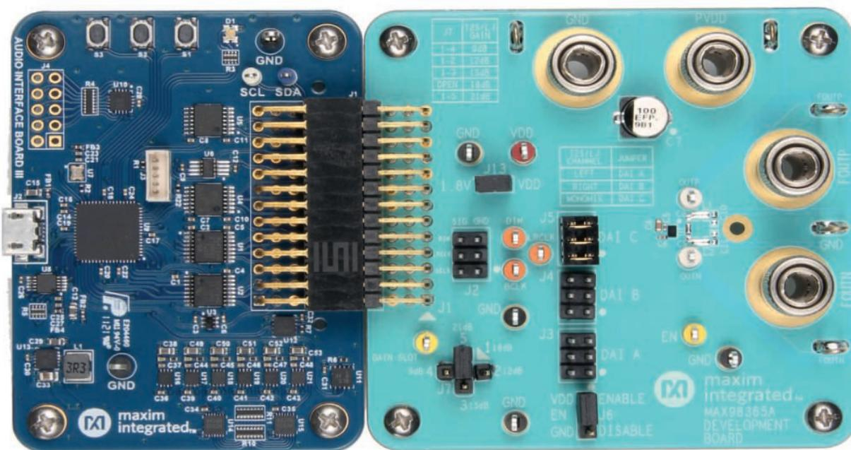
**Рис. 10. Отладочная система MAX98365**
