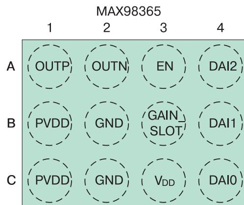
**Рис. 3. Расположение выводов на корпусе усилителя (вид снизу)**
