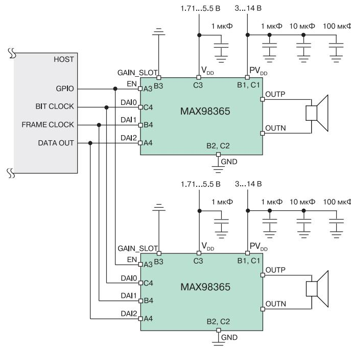
**Рис. 5. Пример усилителя для воспроизведения стереофонического сигнала с использованием MAX98365**
