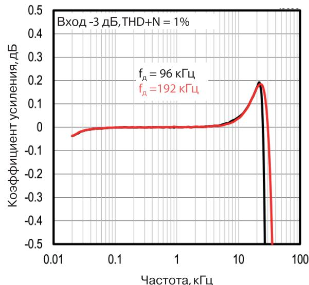
**Рис. 9. Типовые амплитудно-частотные характеристики при различных частотах дискретизации**
