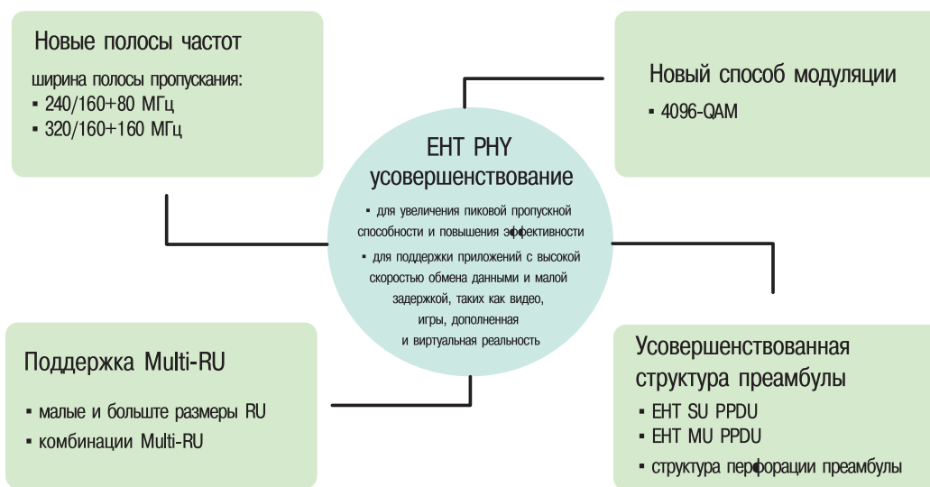
Рис. 2. Основные улучшения на физическом уровне для высокой пропускной способности в полнодуплексном режиме
