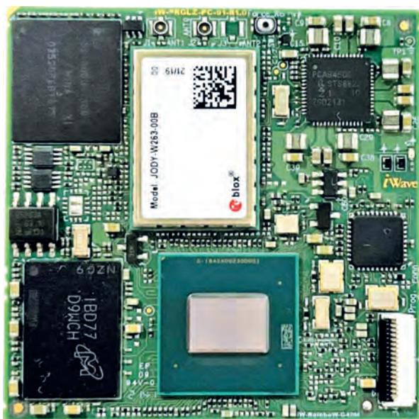
Компания iWave Systems выпустила систему-на-модуле iW-RainboW-G40M i.MX 8M, соответствующую стандарту SGET OSM (модуль открытого стандарта), на базе процессора NXP i.MX 8M Plus, разработанного для приложений V2X и IIoT, в формате OSM Size-L (45×45 мм) [1, 2].
