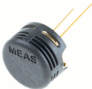
Рис. 1. Аналоговий датчик відносної вологості HS1101LF
