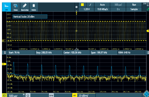
Рис. 8. Аналоговий сигнал та його спектр на екрані осцилографа
