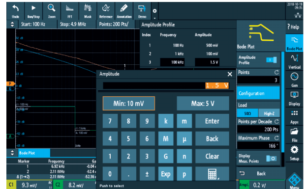
Рис. 12. Вихідний рівень сигналу генератора може змінюватись користувачем під час вимірювання для збільшення відношення сигнал/завада
