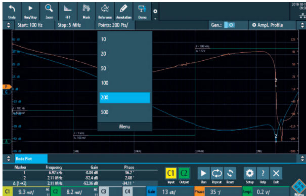
Рис. 13. Роздільна здатність вимірювання може змінюватись за рахунок зміни кількості точок на декаду
