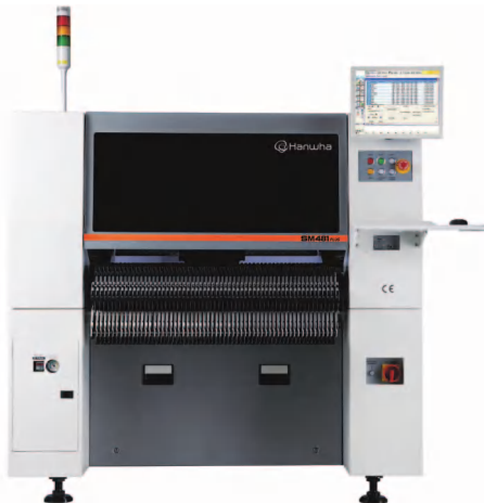
Рис. 2. Встановлювач електронних компонентів Hanwha SM481 PLUS
