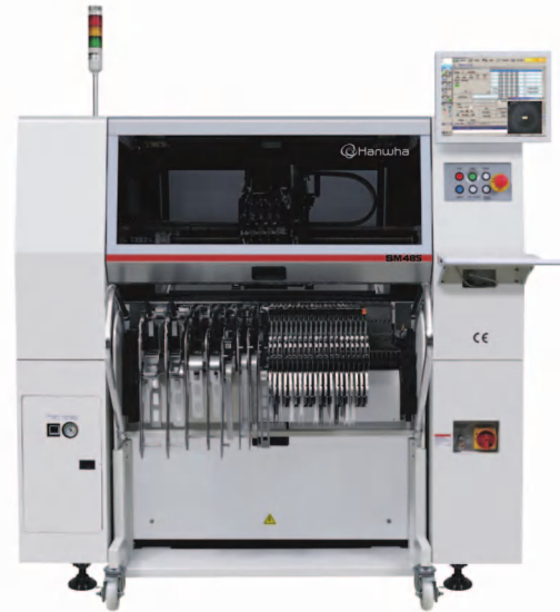
Рис. 4. Встановлювач електронних компонентів Hanwha SM485
