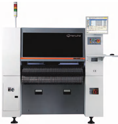
Рис. 3. Встановлювач електронних компонентів Hanwha SM482 PLUS
